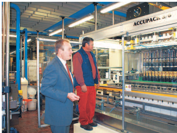
Contrôle du travail de l'encartonneuse et l'encaisseuse de MASPACK.
