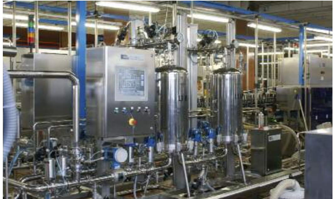
Die vollautomatische Filtrationsanlage von Inotec ist mit 2 parallelen Filterlinien bestückt.
